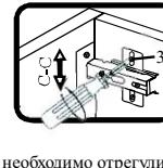
Если необходимо отрегулировать створку по высоте, нужно ослабить винт 3, отрегулировать створку в направлении С-С, а затем затянуть винт 3.
