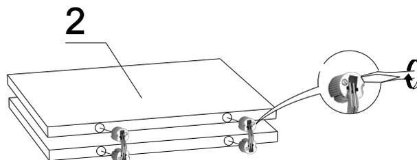
6. Забейте "шкант механический" в торцы крышек и доп. крышек согласно рисунку.
