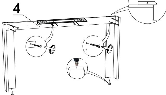
3. Привинтите поперечные царги к продольным с помощью евровинтов, привинтите скобы саморезами 3,5\*16.
