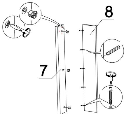
2. Прикрутите раздвижной механизм саморезами 3,5\*16, прикрутите опоры профилем Н-24 к царгам (см. рисунок) с помощью саморезов 3,5\*30, вставьте втулку подпятника и ввинтите подпятник.
