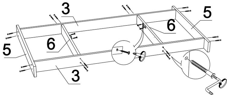
4. Соберите каркас с помощью шкантов и эксцентриковых стяжек, привинтите второй профиль опоры саморезами 3,5\*30, привинтите пандус саморезами 3,5\*20.
