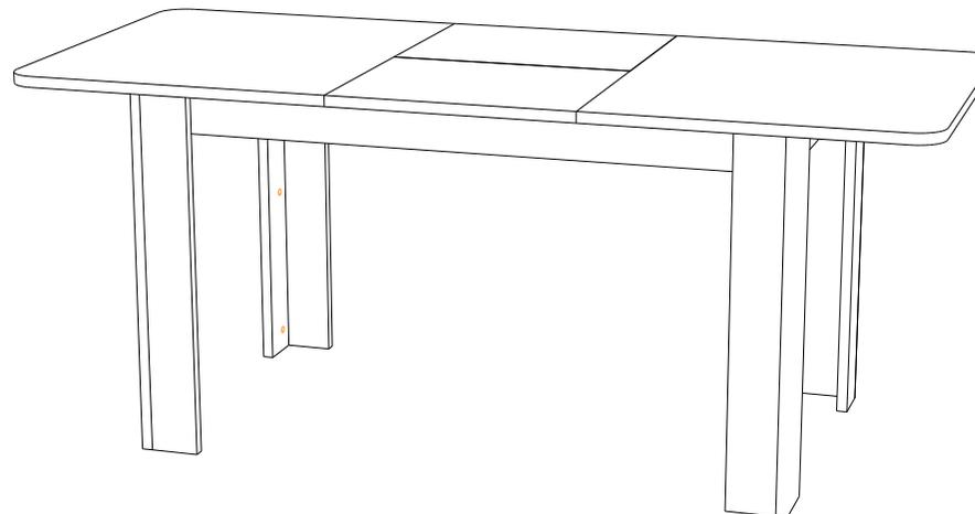
1. Соберите опоры стола с помощью шкантов и эксцентриковых стяжек.
